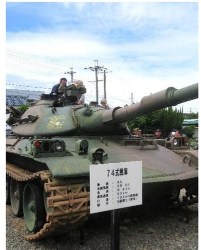
◇74 式仕様:乗員 4 人重量 35t 全長 8.19m 最高速度 45km 口径 90mm 製作三菱重工
