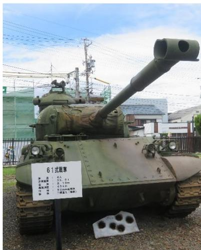
◇61 式仕様:乗員 4 人重量 38t 全長 9.41m 最高速度 55km 口径 105mm 製作三菱重工
