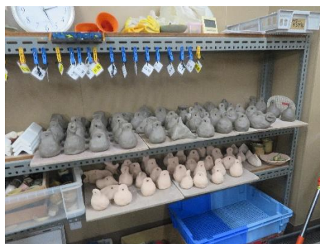
◇上段が完成品 54 個(乾燥後 600℃で焼成すると下段のように新聞紙が 燃えて空間が出来、珠が動いて音が出る)
